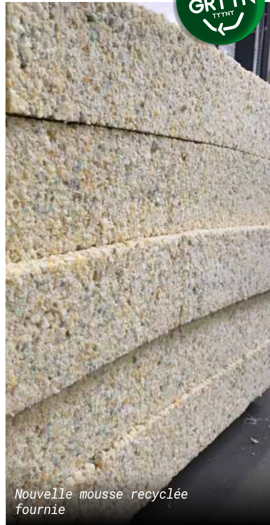
Complexe mousse habituelle en PU et tranche de mousse recyclée 15 cm
