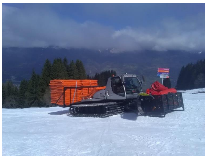
Exemple d'engin de damage équipé pour le transport de matelas
