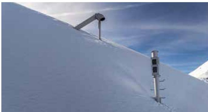
Le NivWatch™ marque une avancée dans la surveillance des avalanches déclenchées préventivement. Ce mât de mesure automatique et autonome en énergie est directement implanté dans les couloirs d'avalanches. Cet outil d'aide à la décision fournit des informations cruciales via le logiciel SAFETY-cs pour une gestion efficace avant, pendant, et après le déclenchement d'avalanches.
